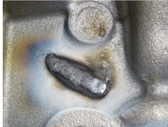
Kurze Schweißraupe vor dem Entfernen der Schlacke
